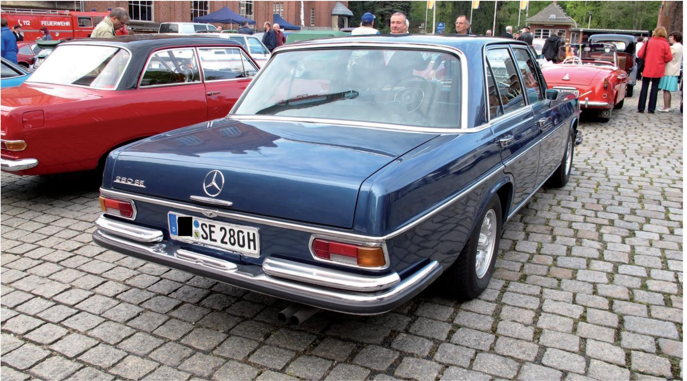
Der Mercedes 280 SE der Baureihe W 108 wurde in den Jahren 1968 bis 1972 gebaut. Der Einspritzmotor bringt eine Leistung von 160 PS. Die Höchstgeschwindigkeit beträgt 193 km/h, bei Automatic-Modellen 188 km/h. Von 0 auf 100 km/h beschleunigt der Wagen in 11 Sekunden. Der Tank fasst 82 Liter, der Verbrauch liegt bei 16 Liter Super auf 100 km (Automatic 17 Liter).
